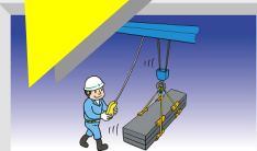
床上操作式クレーン
