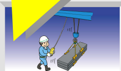
床上操作式クレーン
